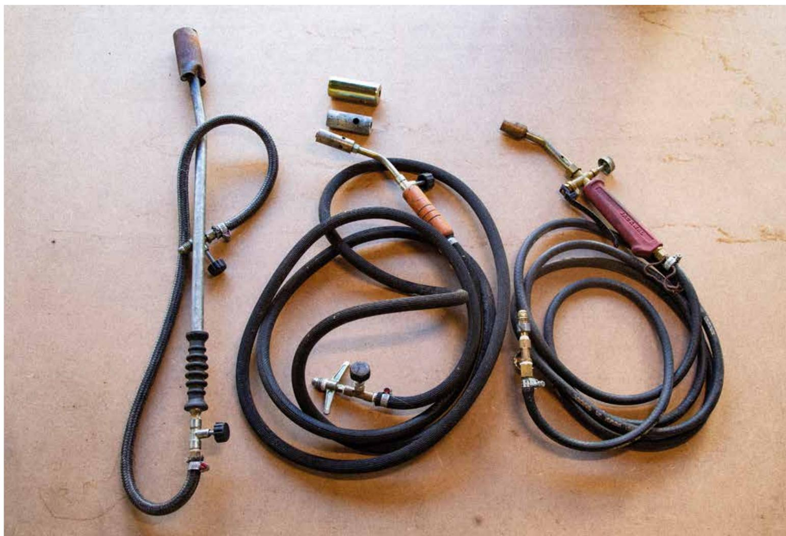
Os Maçaricos são utilizados para dar cor e tratar o cana-da-índia. Existem vários modelos e todos cumprem a função, variando no uso de gás e acabamento da peça. Recomendo o modelo do meio da foto a seguir, que é de baixo custo e cumpre bem a função com diferentes opções de bico.
