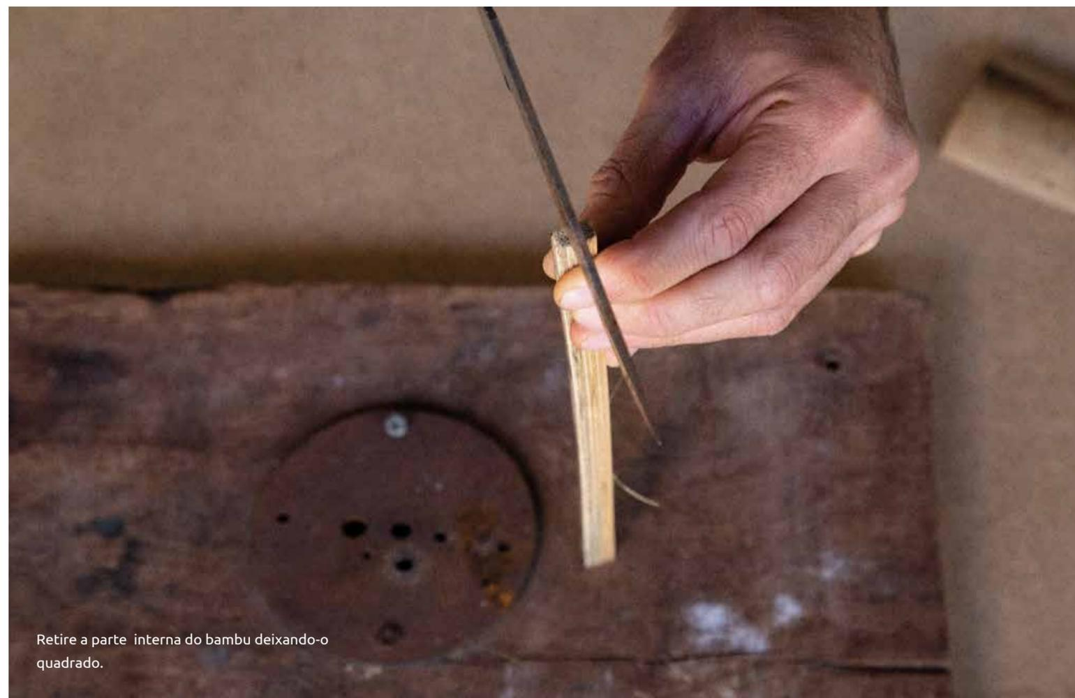
Retire a parte interna do bambu deixando-o quadrado.
