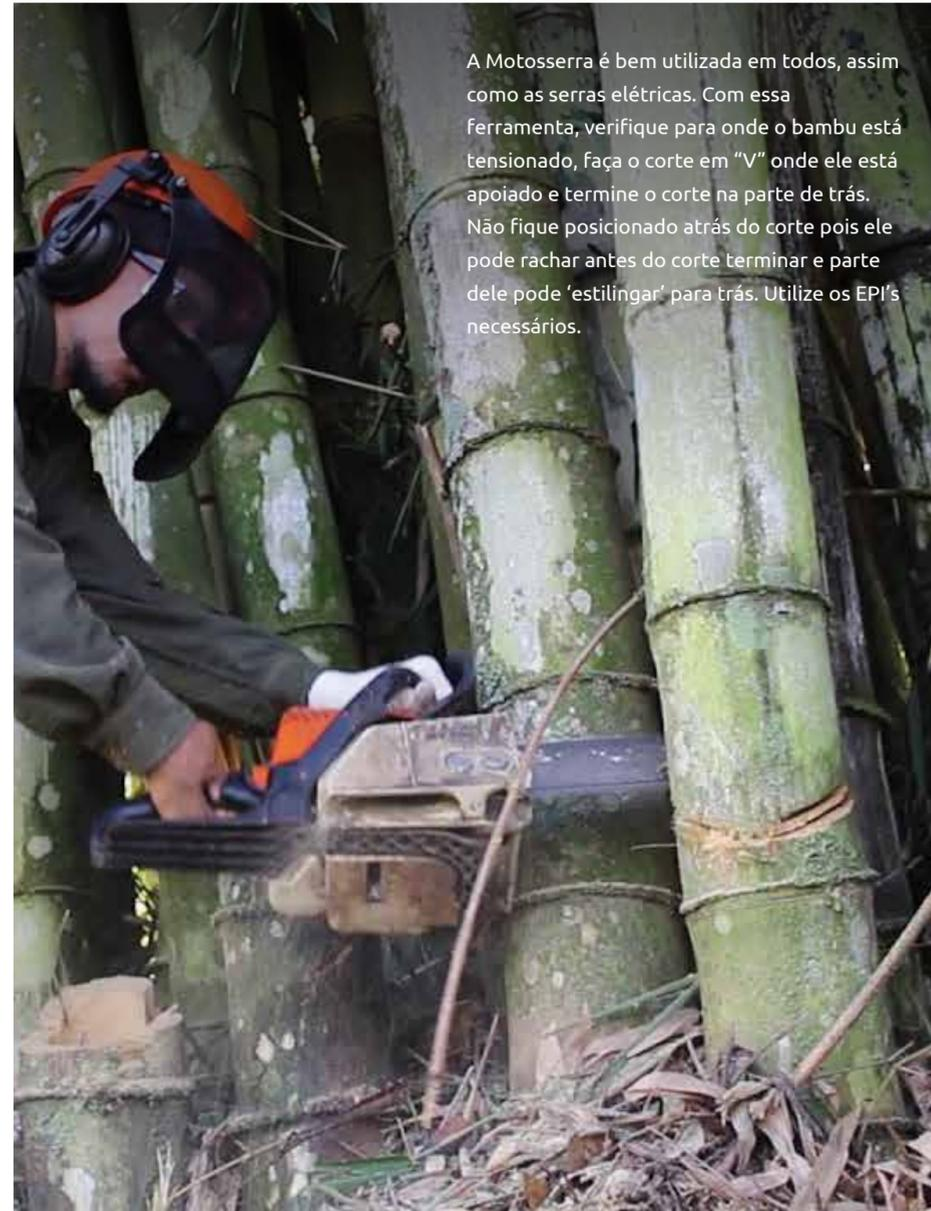
A Motosserra é bem utilizada em todos, assim como as serras elétricas. Com essa ferramenta, verifique para onde o bambu está tensionado, faça o corte em "V" onde ele está apoiado e termine o corte na parte de trás. Não fique posicionado atrás do corte pois ele pode rachar antes do corte terminar e parte dele pode 'estilingar' para trás. Utilize os EPI's necessários.
