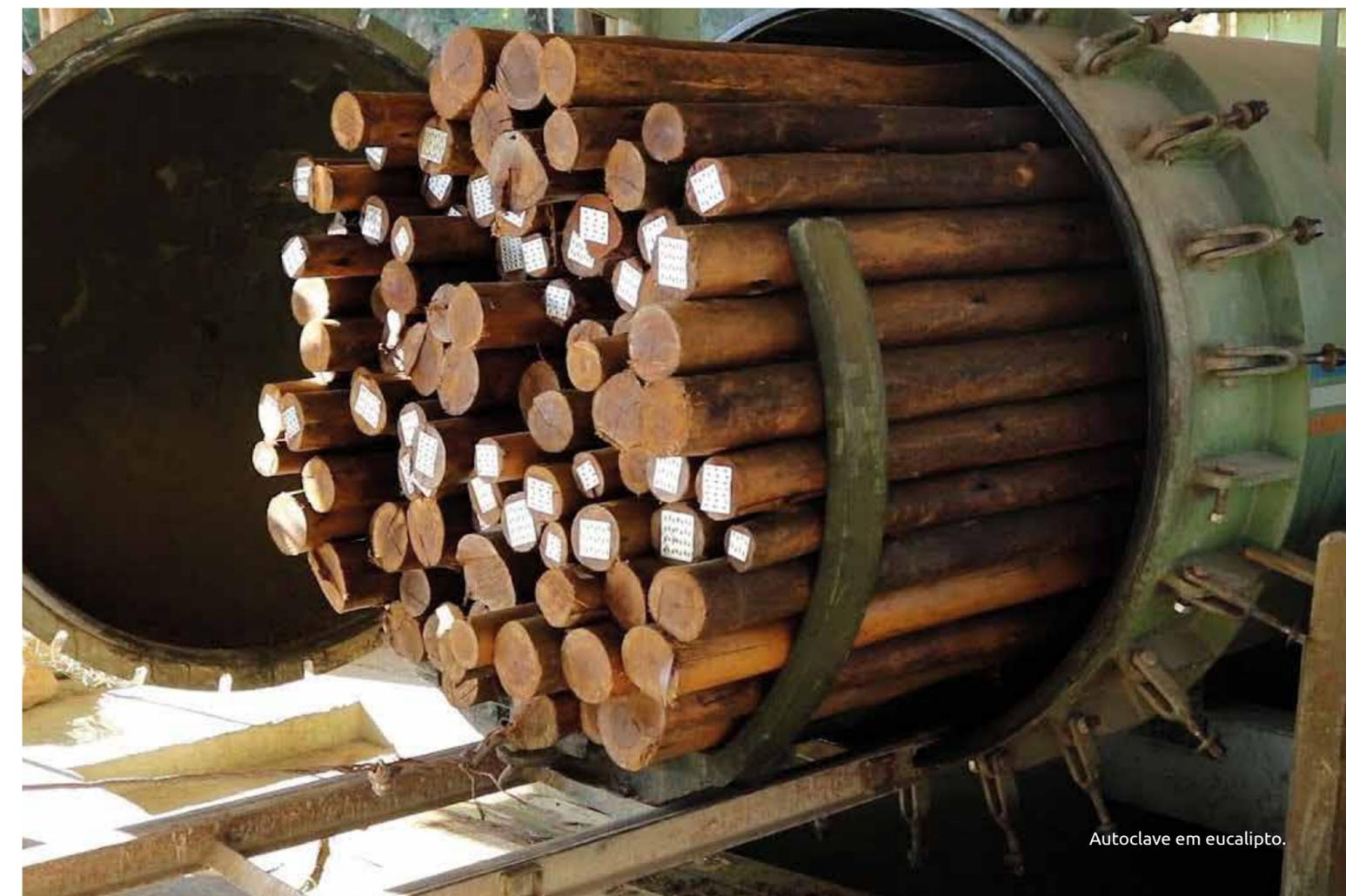
Autoclave em eucalipto.
